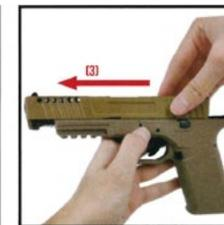
Entnehmen Sie das Magazin. Ziehen Sie den Schlitten nach hinten (1) während Sie den Schlittenentriegelungsknopf (2) wie abgebildet, auf beiden Seiten nach unten ziehen. Entfernen Sie nun den Schlitten, indem Sie ihn nach vorne vom Griffstück herunterschieben (3).
